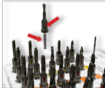
2- Vérifier que le foret choisie correspond à la longueur et au diamètre requis.
