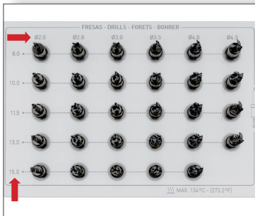
1- Seleccionar según secuencia de fresado y longitud.
